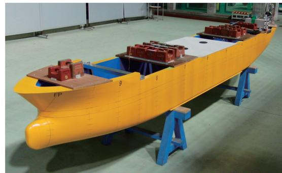
図1 対象船模型の自由航走試験用セッティング
