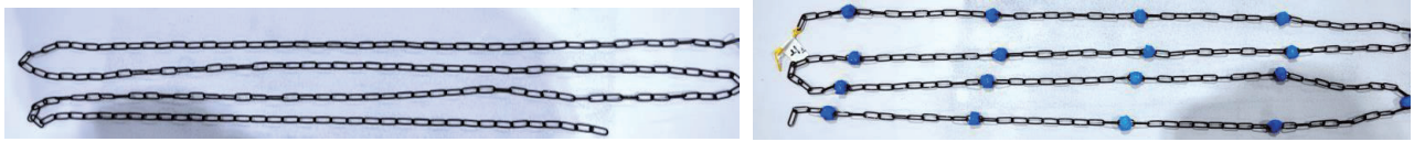
図6 錨鎖模型 (左図：マーカーなし，右図：マーカー有)
