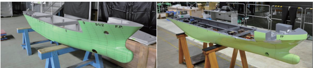
図4 模型船外観図 (左図：内航タンカー，右図：内航フェリー)
