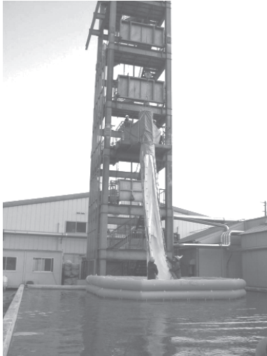
(a) シュータの下にプラットフォームを設置
