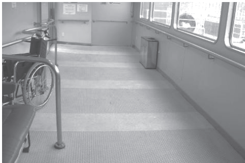
図8 バリアフリー客席及び車いすスペースへ通 じる船内移動通路と連続した手すり
