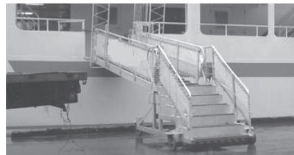
図4 潮位差の大きい港での階段式タラップ
