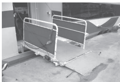
図 12 バリアフリー化されたタラップ
