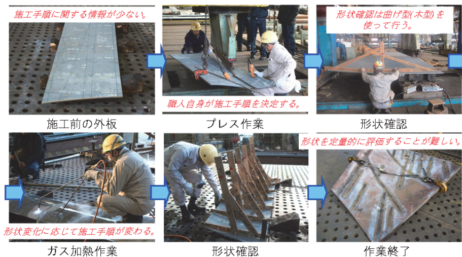
図2 外板曲げ加工の手順
