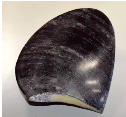
図27 船用プロペラモデルの成形結果
