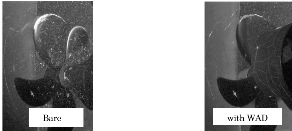
図 3.6 省エネ付加物の有無によるキャビテーションパターンの比較
