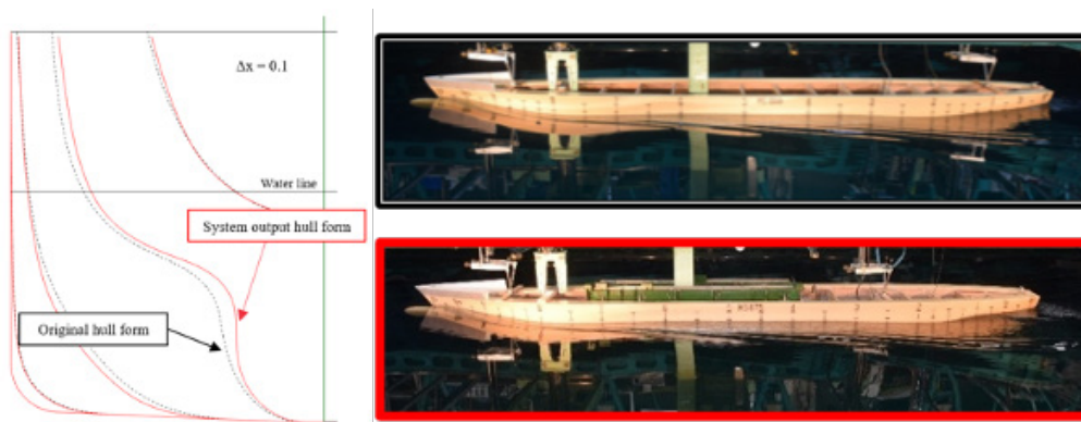
図 2.6 伴流設計システムの実用化検証（船型比較）
