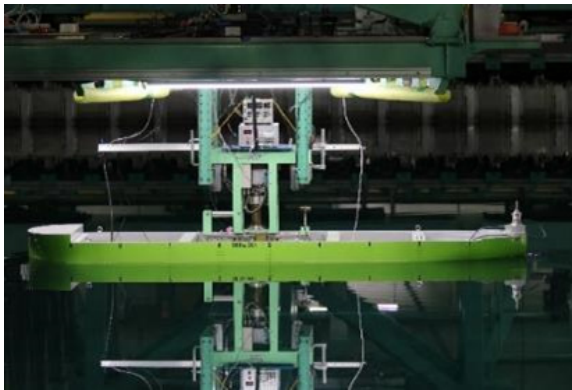
図 2.12 拘束模型試験の様子
