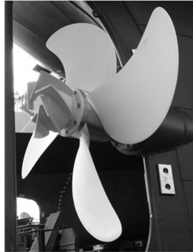
図 7.22 複合材料製実船プロペラ<sup>145)</sup>
