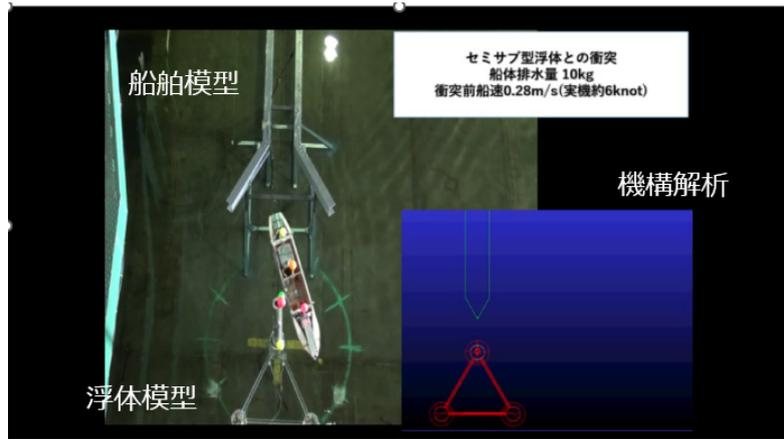
図 2.10 水槽試験における船舶と洋上風力発電施設浮体の衝突時の様子と同機構解析
