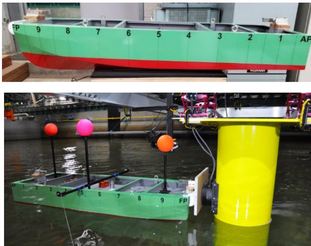
図 2.13 研究対象 CTV (上) と風車タワーに対する CTV 押し付け荷重計測時の水槽試験状況 (下)
