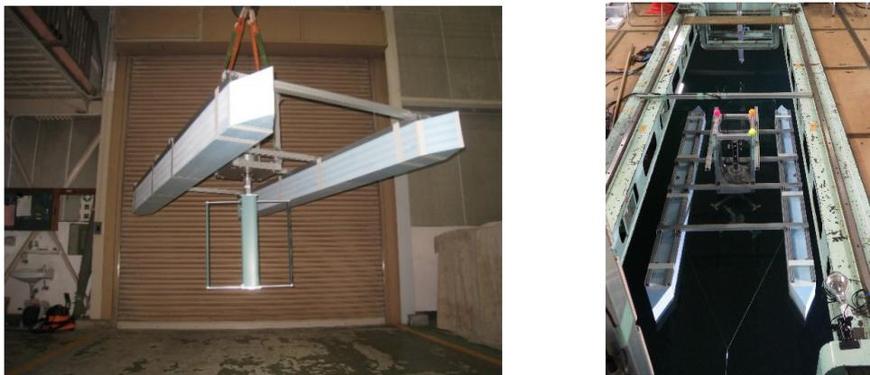
図 4.4 浮体式垂直軸型発電施設の水槽試験用模型（左）と試験の様子（右）
