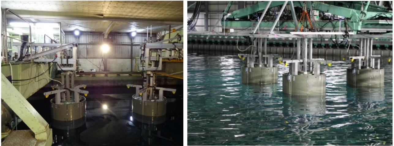
図 3.2 着床式 PAWEC のアレイ波干渉影響を考慮した同調制御の有効性確認試験 (左 : 2 浮体, 右 : 3 浮体)
