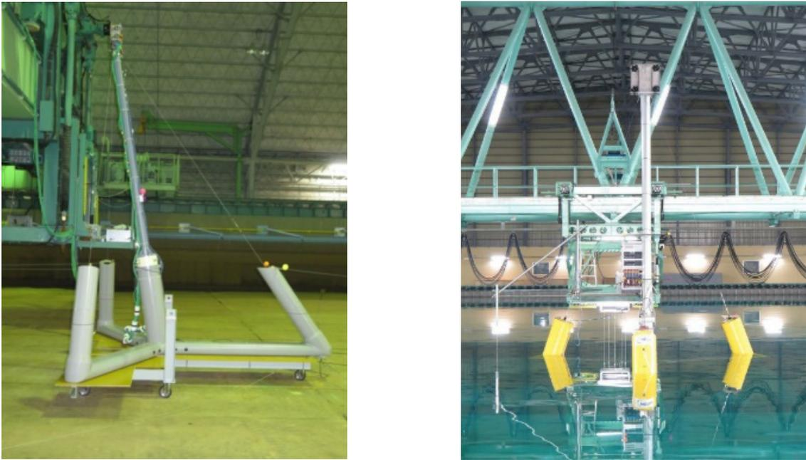
図 2.1 1点係留型の浮体式洋上風力発電施設の水槽試験模型（左：縮尺 1/30，右：縮尺 1/15）
