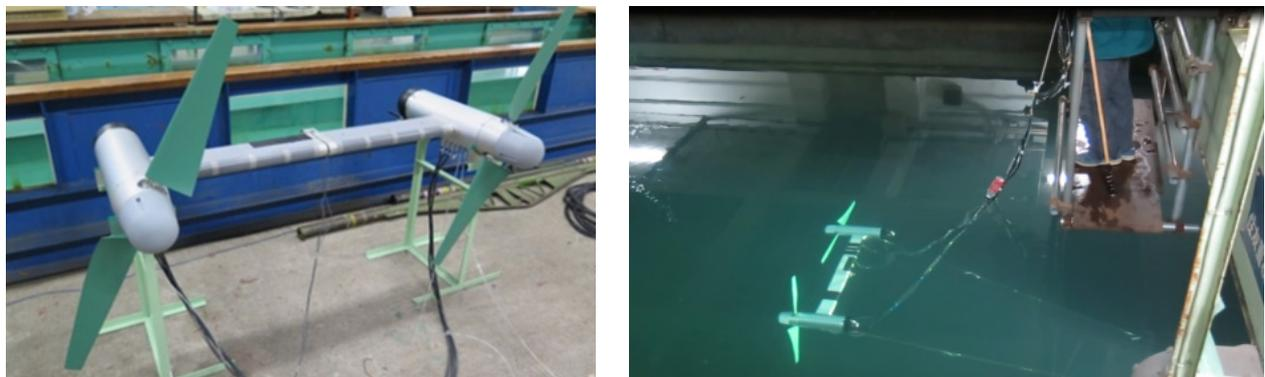
図 4.2 水中浮遊式水平軸型発電施設の水槽試験用模型（左）と水槽試験の様子（右）
