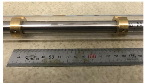
図 2.3.2 ライザー模型の外観
