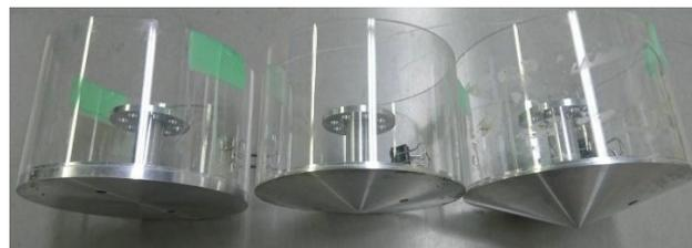
図 2.4.2 タレット模型（左から底面勾配角が 0, 10, 20 deg）
