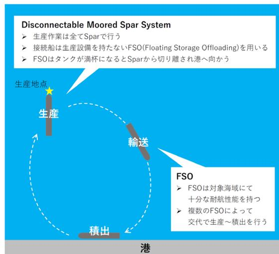
図 2.5.2 FSO を用いた石油サプライチェーンのオペレーション案
