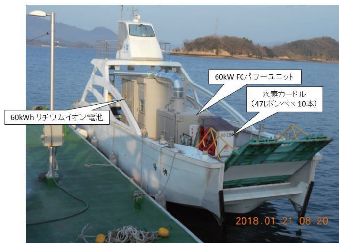
図1 水素燃料電池システムの実船試験に用いた小型実験船「神峰」
