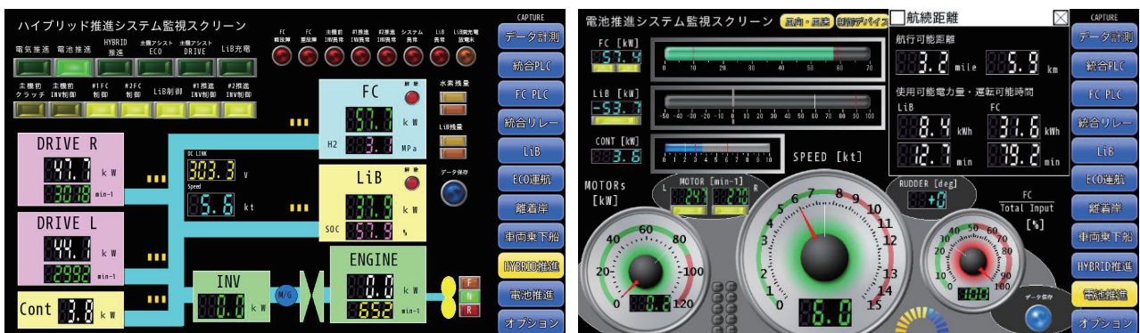
(a) 電気推進システムの監視画面
