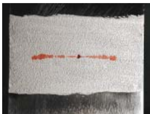
き裂進展に伴う発色（試験片幅 70mm）
