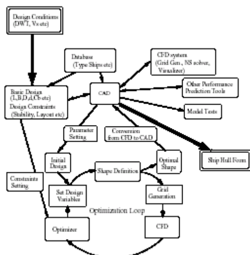
CAD/CFD 統合設計システムのコンセプト
