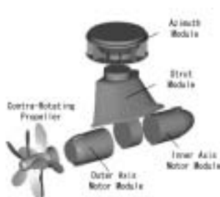
図1二重反転プロペラ型ポッド推進器のモジュール構造
