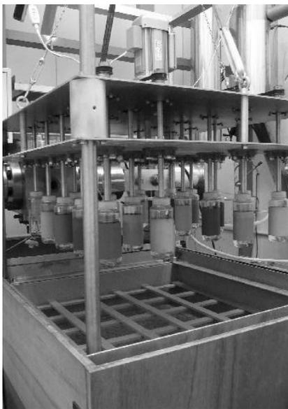
多数検体の試験を可能にした溶出試験装置
