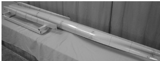
図1: トリマラン船型の供試模型
