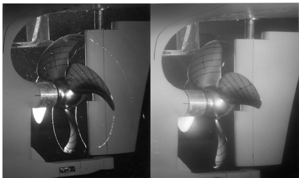
原型（左）と改良型（右）プロペラのキャビテーション
