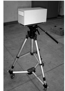
図1 距離とビート周波数の関係 図2 開発したミリ波レーダ
