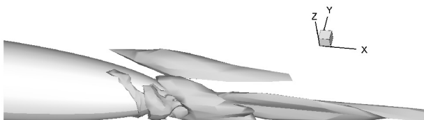
図. 速度勾配テンソルの第二不変量を用いて可視化された楕円体後端付近の渦構造(迎角10°)
