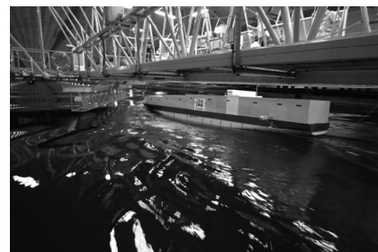
図 曳航水槽での風・波下自由航走模型試験
