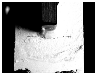
溶接継手での発色状況
