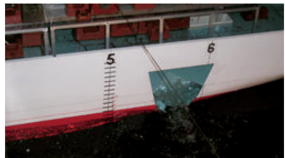
図 日本で実施した波浪中での損傷客船の安全性評価
