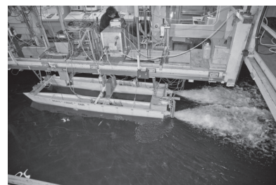
図 改良デルフトカタマラン船型の自航試験
