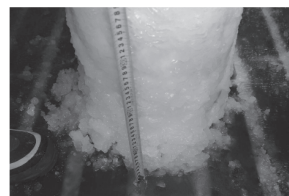
図 灯台模型への着氷及び剥離の状況
