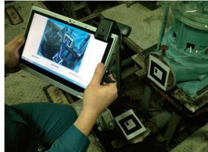
図 配管施工支援ARシステムの実証試験風景
