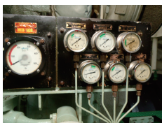
図 主機の機付計器盤と対応する点検項目
