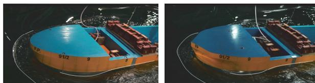
図 水槽試験の様子（左：原型，右：COVE）
