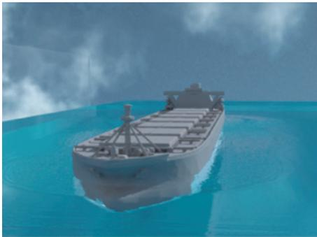
図1 船舶周りの大規模自由表面流計算
