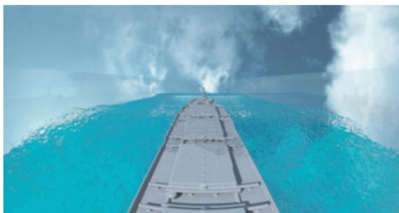
図 船舶と自由表面の連成解析結果
