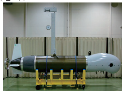
図 半没水型洋上中継器（全長4m）
