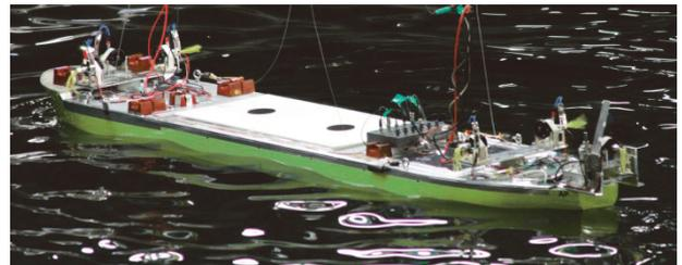
図 補助推力装置と風荷重模擬装置を用いた多方向不規則波中の自由航走模型実験
