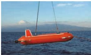
図 駿河湾沖実海域試験での航行型AUV初号機
