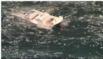
図 多方向不規則波中でのブローチング現象
