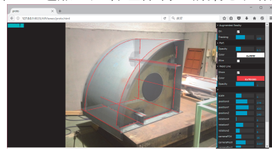
図 溶接作業支援ARアプリケーションの様子
