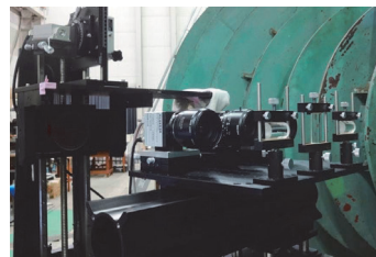
図 組合せラインCCD法を用いた三次元形状計測装置
