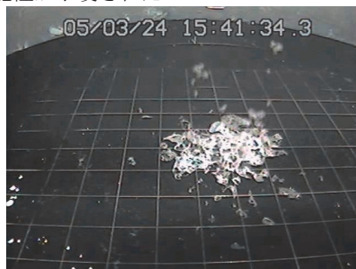
図 高圧タンク内でのCO 2 ハイドレート分解の様子
