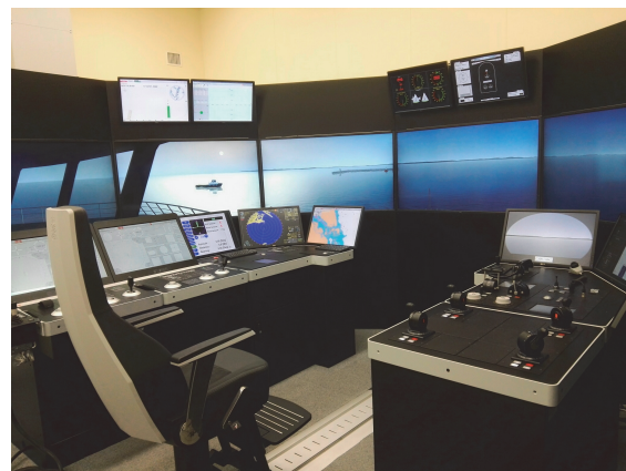
図 1 DPシミュレータの操船室
