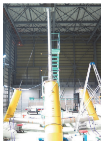
図 縮尺1:15の水槽試験模型
