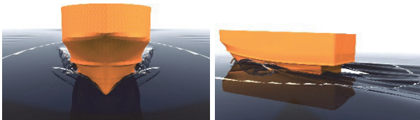
図 チャインによる波切れの可視化 ( F_n=1.052 )
