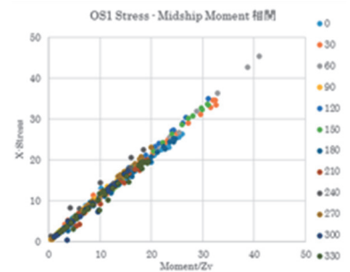
図 長手方向応力の推定精度
