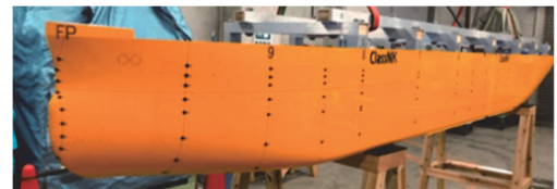
図 波浪中実験に用いた模型船 (バルクキャリア)
