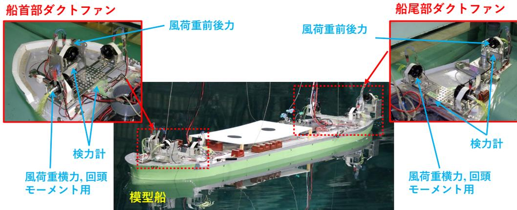
図3 風荷重模擬装置を搭載した自由航走模型船
