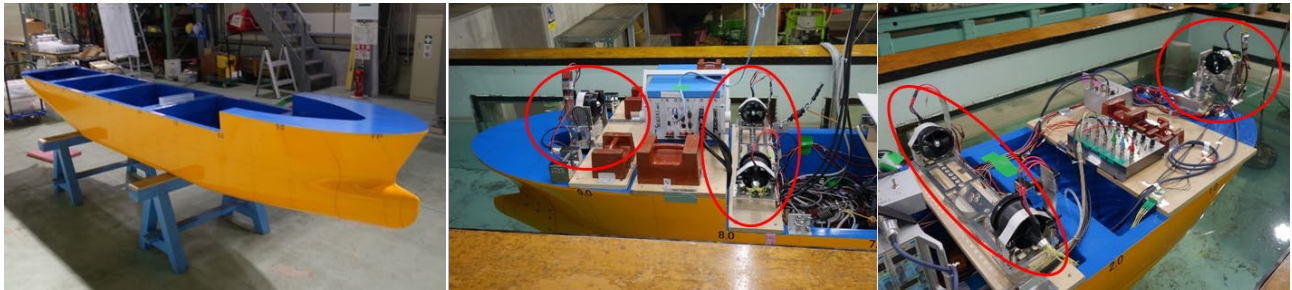
図2 対象船の模型船（左から：全体外観・艤装時の船首部及び船尾部，赤丸：風荷重模擬装置ダクトファン）
