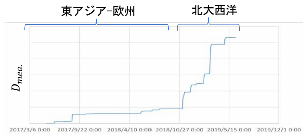
図 3.8 Ship D の航路及び疲労被害度の増加履歴
