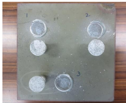
亜鉛ショッププライマーの密着力:15-21MPa JIS K 5600-5-7:2014(試験法) JIS K 5600-1-4:2004(被着面前処理) #80 ペーパーによる 10 往復研磨
