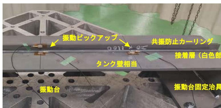
図 4.5 振動ピックアップ(加速度計) 取付状態
