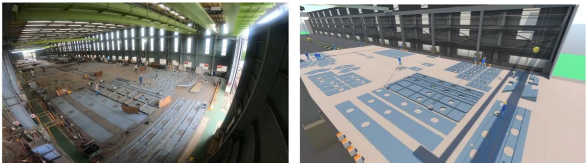
図3 小組立工程の建造シミュレーション（浅川造船株式会社） （左：実際の造船所の様子、 右：建造シミュレータによる計算）
