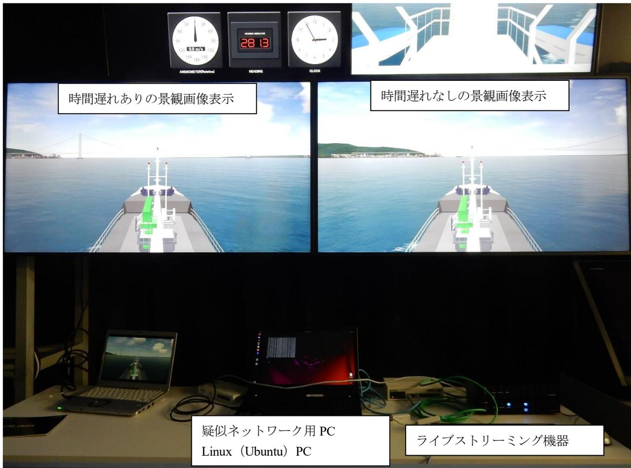
図 2.12 時間遅れの有無を実現したシミュレータ景観画像（左に変針時，左側画面が 5 秒遅れ）
