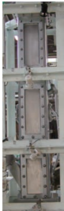
図-5 空塔速度の違いによる流動様式の違い (左:気泡流動状態、中央:乱流流動状態、右:高速流動状態)
