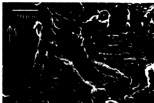
図-7 高サイクル疲労破面におけるストライエーション（破断起点部より 2.0mm, 矢印はき裂進展方向）
