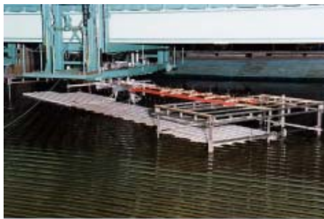
図—7 メガフロート弾性応答の水槽実験（長さ15mのバックボーン模型使用例）
