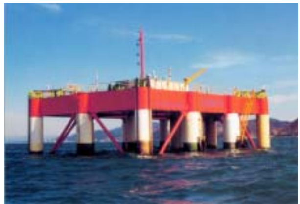
図—2 POSEIDON号の実海域実験（1987年） （長さ30m、幅20m、高さ13.5m）
