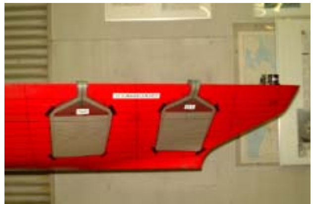
図-1 模型船船首部と圧力センサーフィルム
