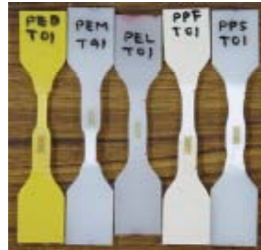
図 - 2 引張試験後の試験片の様相
