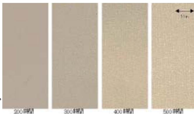
図 - 11 促進暴露後の試験片様相例
