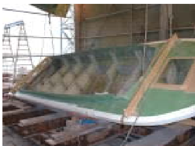
図-7 脱型後の船体
