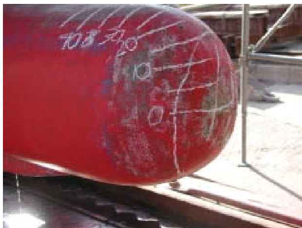
図 3 . バルバスバウの損傷部(t=10)
