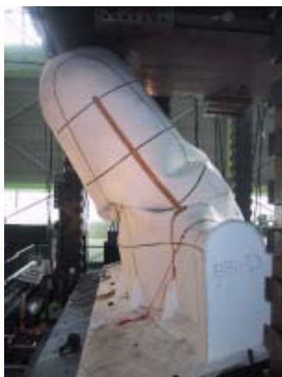
図 5 模型圧潰状況（BB-D 模型）
