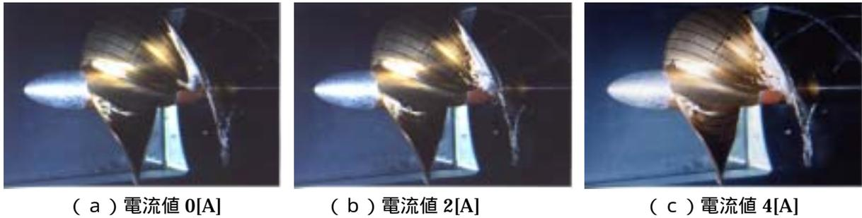
図 - 3 : S C P ( M.P.No.463 ) でのキャビテーションパターンの変化 (  $J = 1.300$   $v = 0.675$  )
