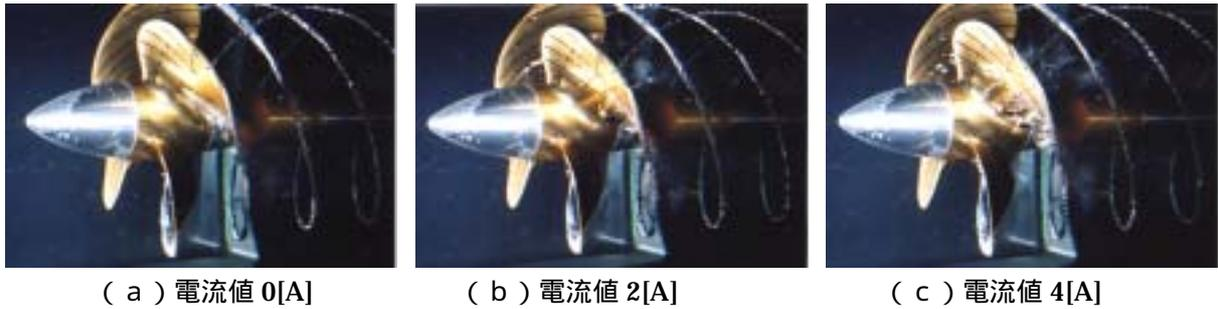
図 - 2 : 在来型プロペラ ( M.P.No.501 ) でのキャビテーションパターンの変化 (  $J = 0.900$   $v = 1.160$  )
