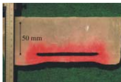
図1 オイル-アイス・サンドウィッチ断面
